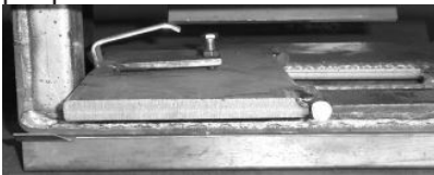
← Retrait de la porte de la voie de dérivation au travers de l'ouverture du catalyseur
