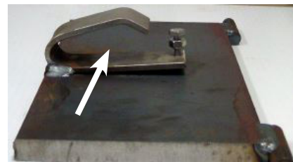
Appliquer du lubrifiant sur le dessous de la rampe du bypass
