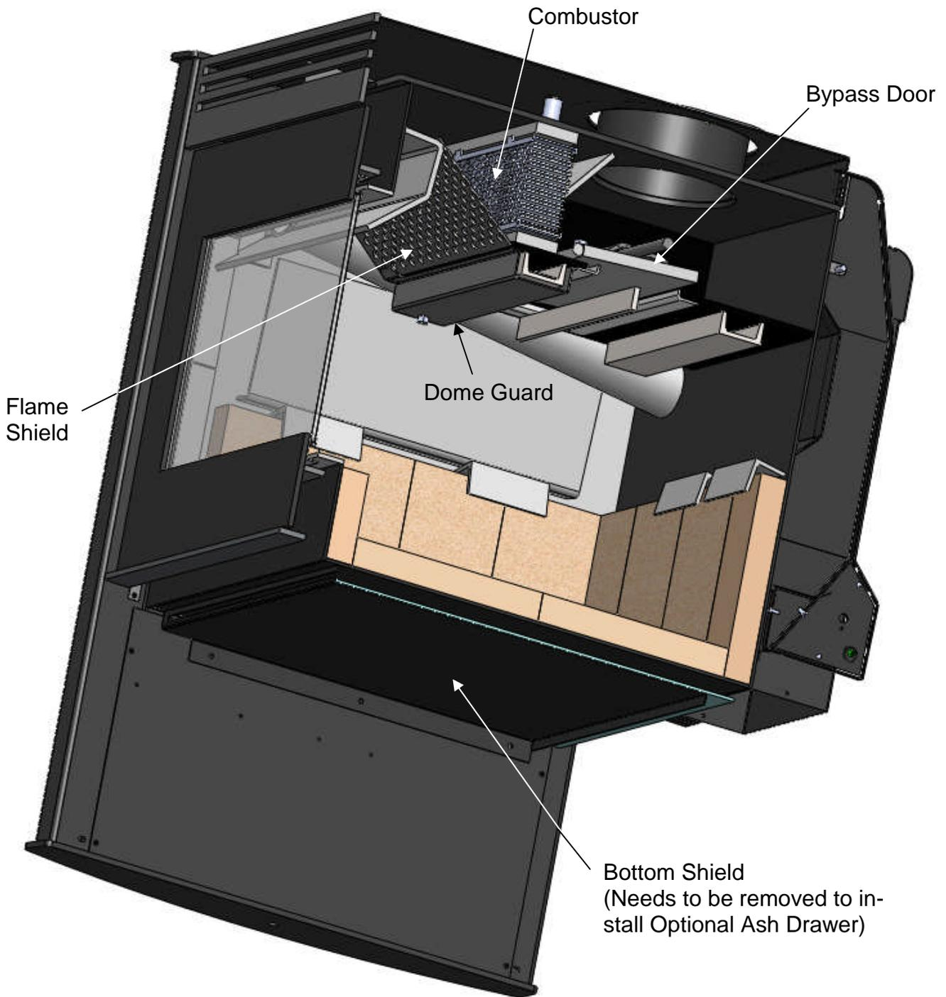
**SIDE CUTAWAY—WHAT IS INSIDE**
